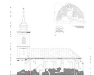
A déli homlokzat és a gótikus ablakkeret rekonstrukciója
